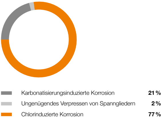
Ursachen für Schäden an Brückenbauwerken
